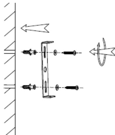
4. Vuelva a ajustar el proyector en el soporte con sus tornillos.
