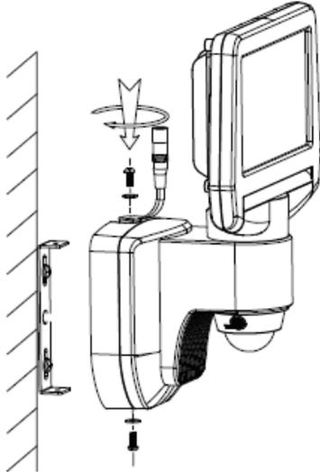
5. Conecte el panel fotovoltaico y el proyector.
